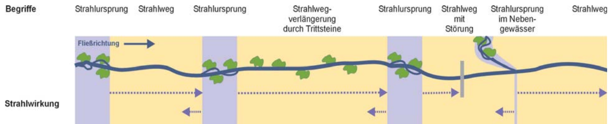
Abb. 2: Elemente der Strahlwirkung und deren Ausprägung in der Laufform eines Fließgewässers. (Quelle: Heft 82; Deutscher Rat für Landespflege)
